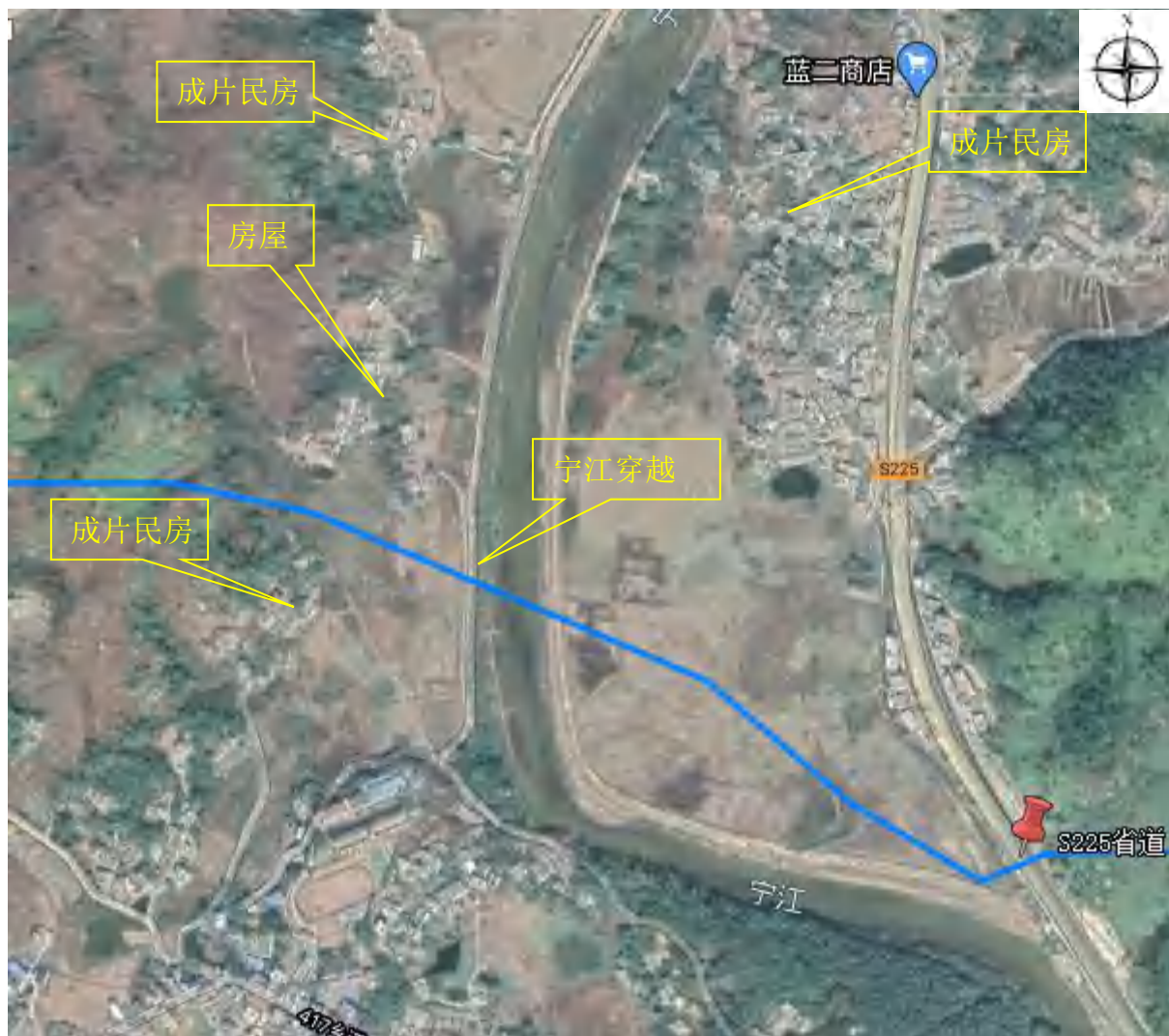
图 3.4-3 宁江定向钻穿越位置示意图
