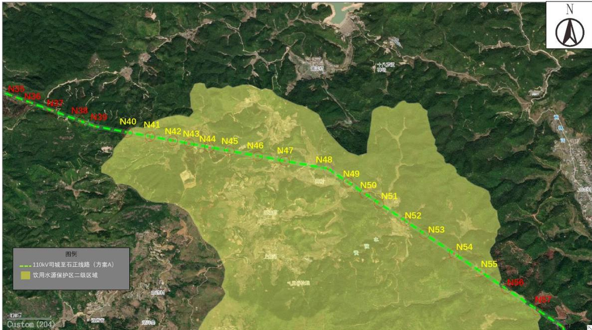
图 3-2 本项目穿越水源保护区塔基分布情况示意图
