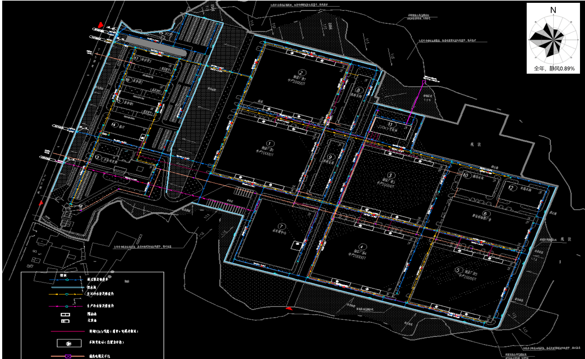
图 8.1-2 事故废水池及事故废水收集路线图
