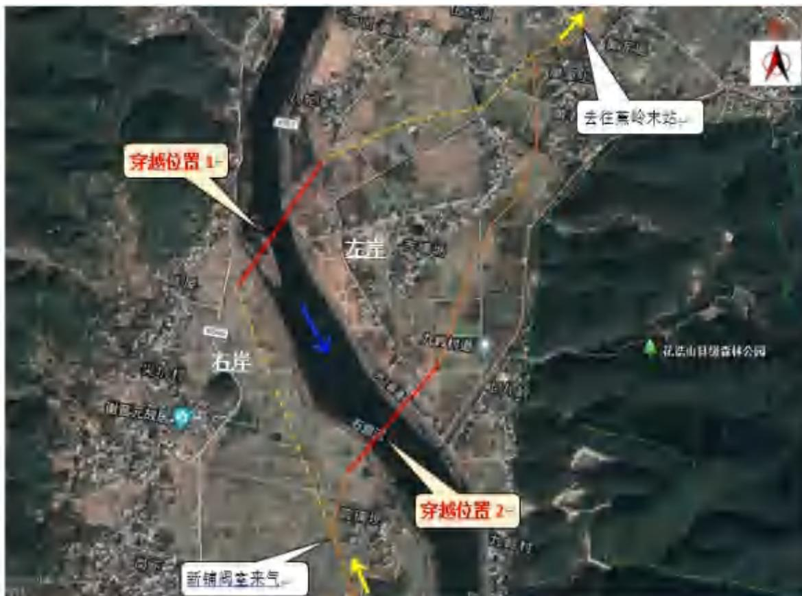
图 3.4-11 石窟河顶管穿越位置示意图
