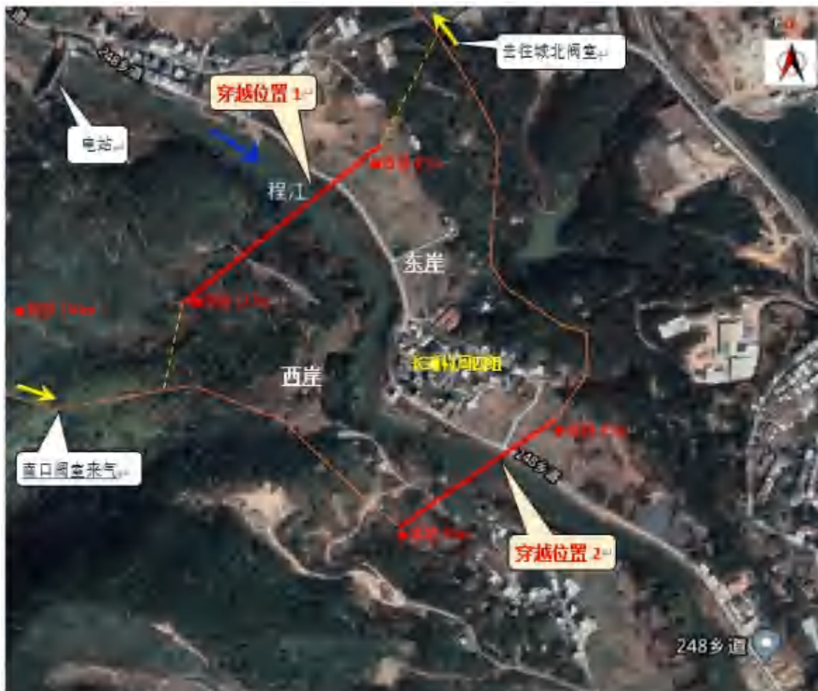
图 3.4-3 程江定向钻穿越位置示意图
