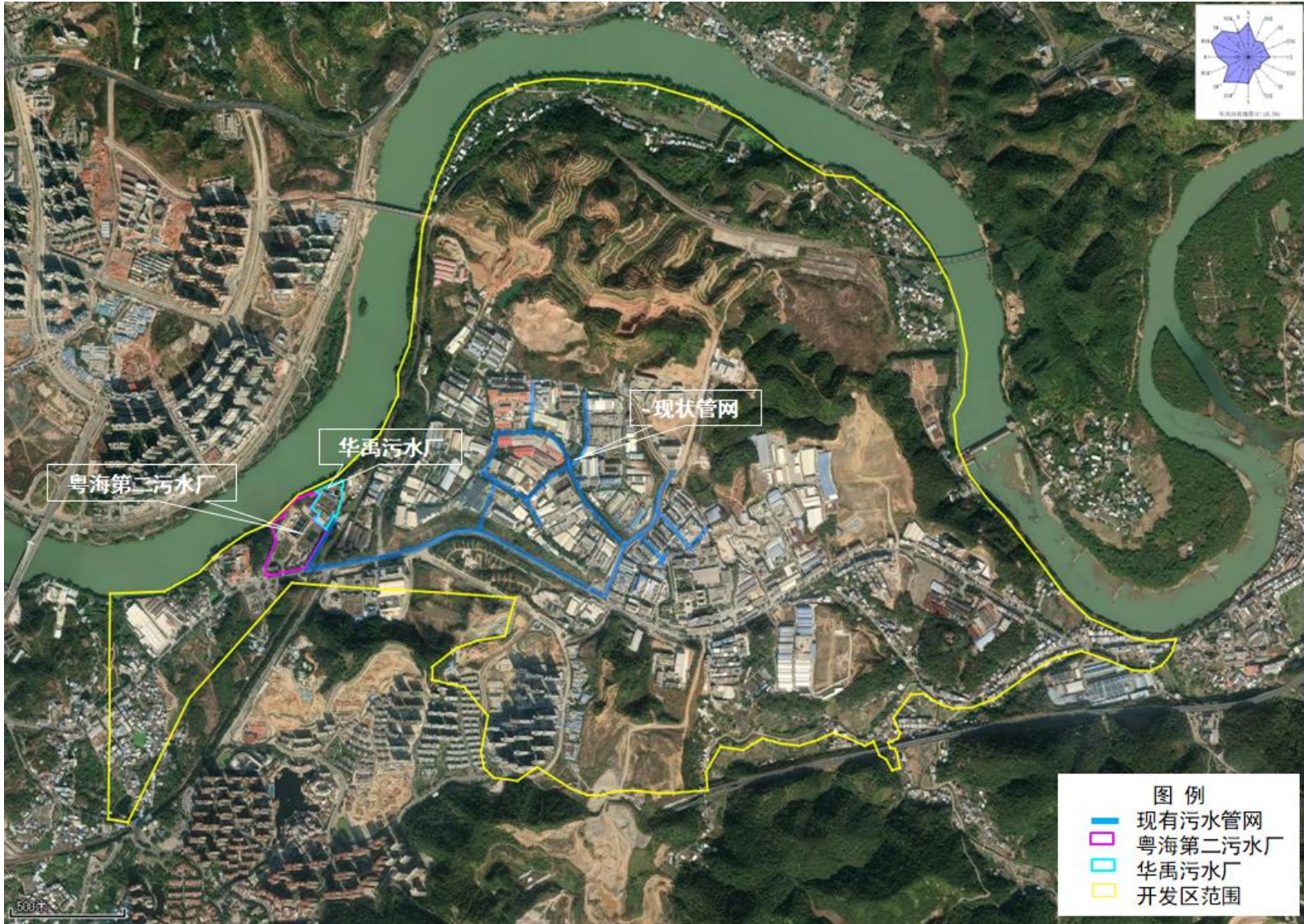
附图 2 开发区现有污水处理厂及污水管网现状图
