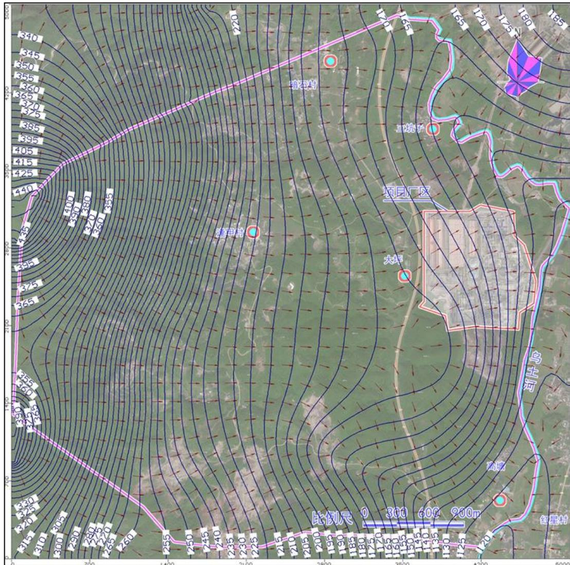
图 6.2.3-1 模拟区地下水等水位线和流场示意图(单位: m)
