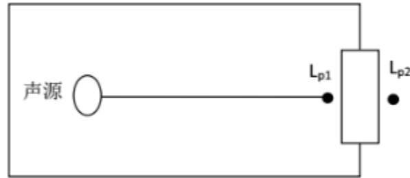
图 5.4-1 室内声源等效为室外声源示意图
