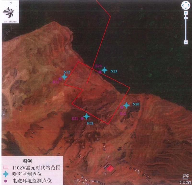
图2 110kV嘉元时代变电站电磁环境、声环境监测点位
