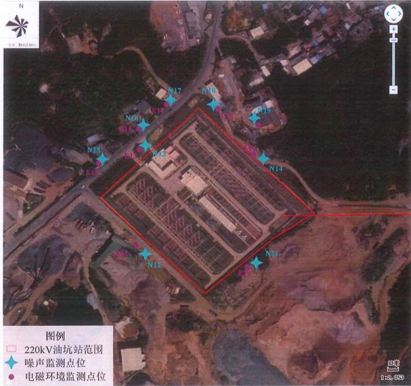
图1 220kV油坑变电站电磁环境、声环境监测点位
