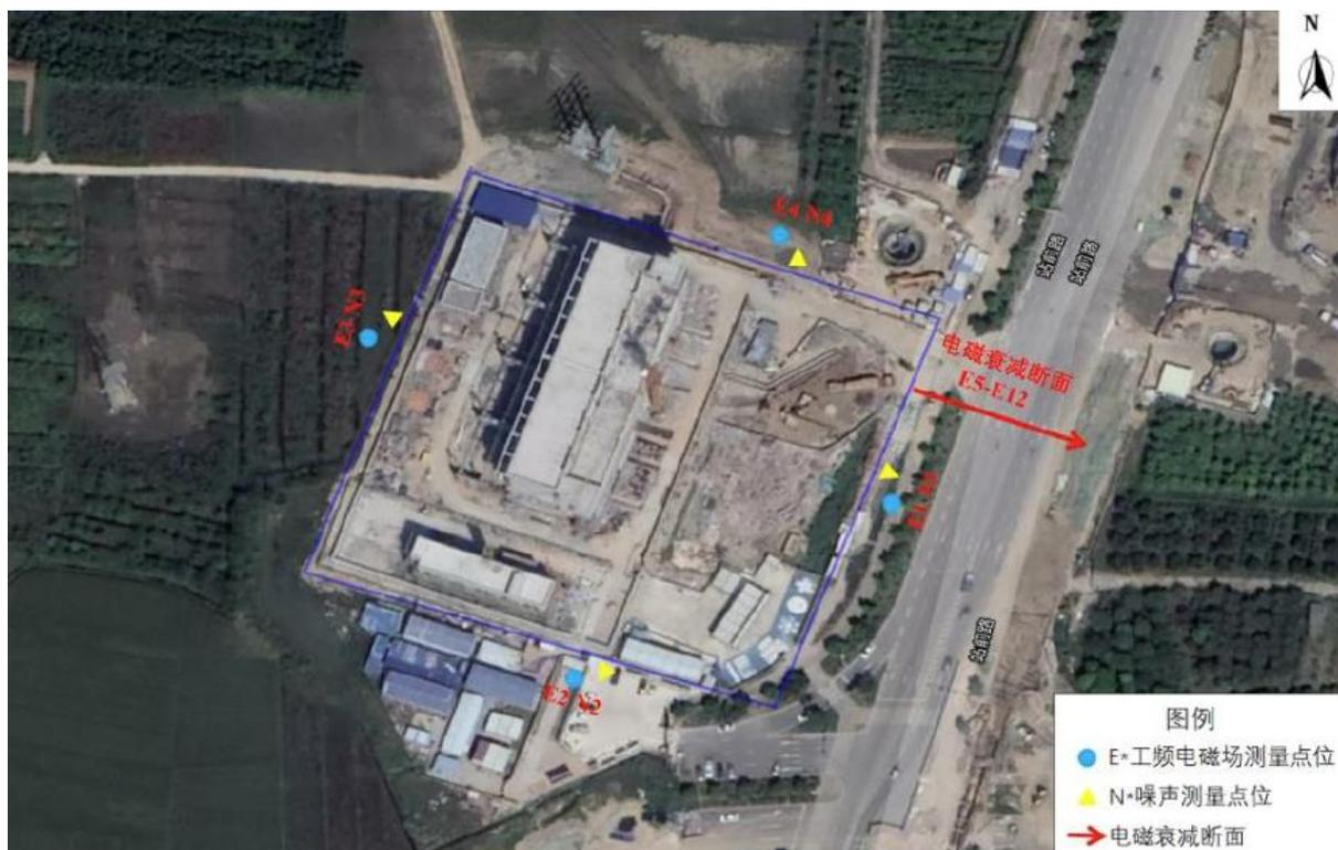
图 8.1-1 220kV 岭塘变电站类比监测布点图
