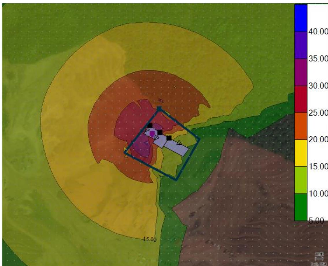
图 4-1 110kV 嘉元时代变电站噪声贡献值预测图
