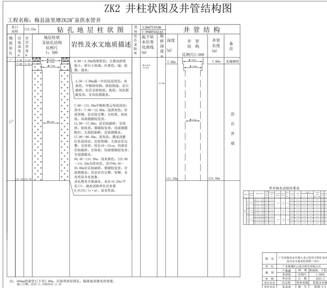
图 1-7 ZK2 井柱状图及井管结构图
