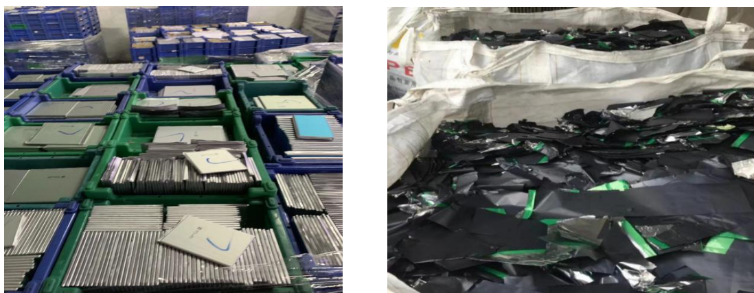
数码废旧电池等包装贮存方式（塑料托盘装） 电池材料极片、极片废边料包装贮存方式
