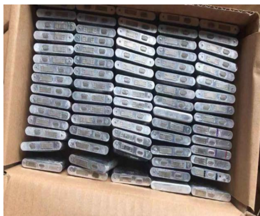
数码类废旧电池等包装贮存方式 (箱装)
