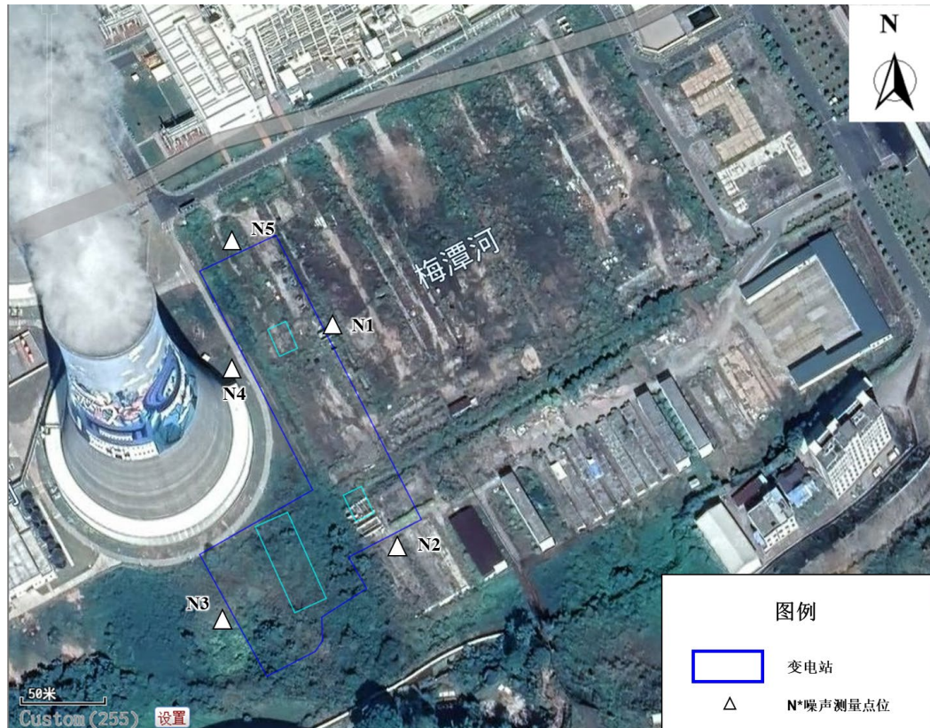
图 4.4-1 500kV 变电站噪声测量布点图
