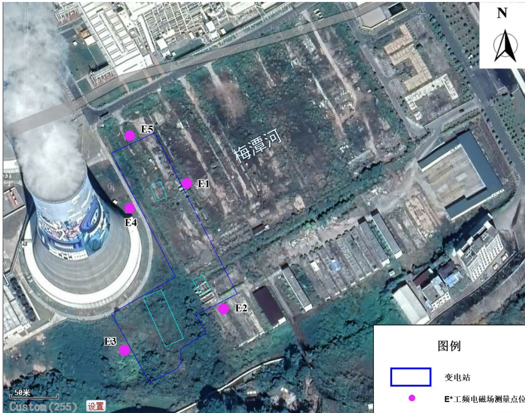
图 4.3-1 拟建变电站电磁测量布点图
