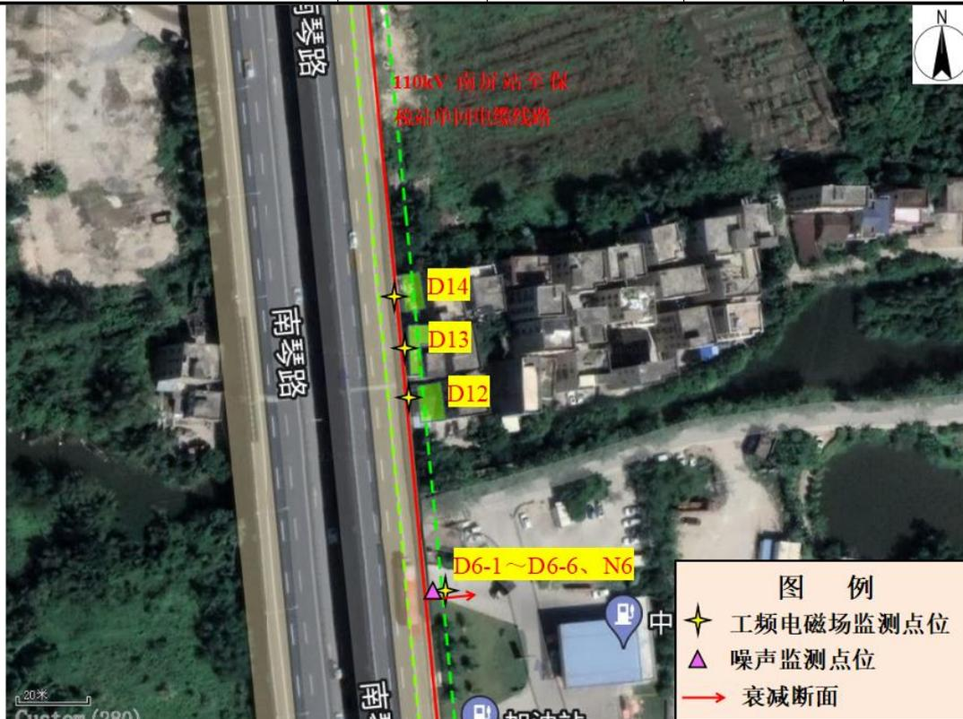
图8-33 110kV烟墩站至保税站单回电缆线路类比监测布点图
