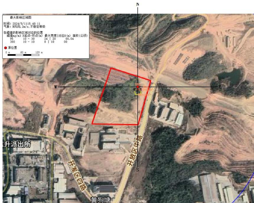
图 5 CO 泄漏事故排放最大影响区域图（最不利气象条件）
