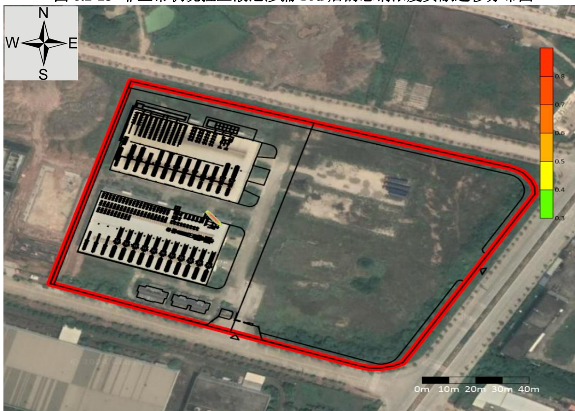
图 6.2-24 非正常状况拉丝液池渗漏 100d 后的总铜浓度贡献迁移分布图
