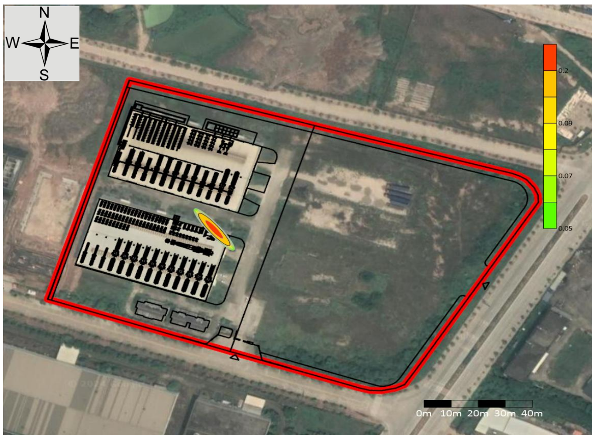
图 6.2-25 非正常状况拉丝液池渗漏 300d 后的总铜浓度贡献迁移分布图
