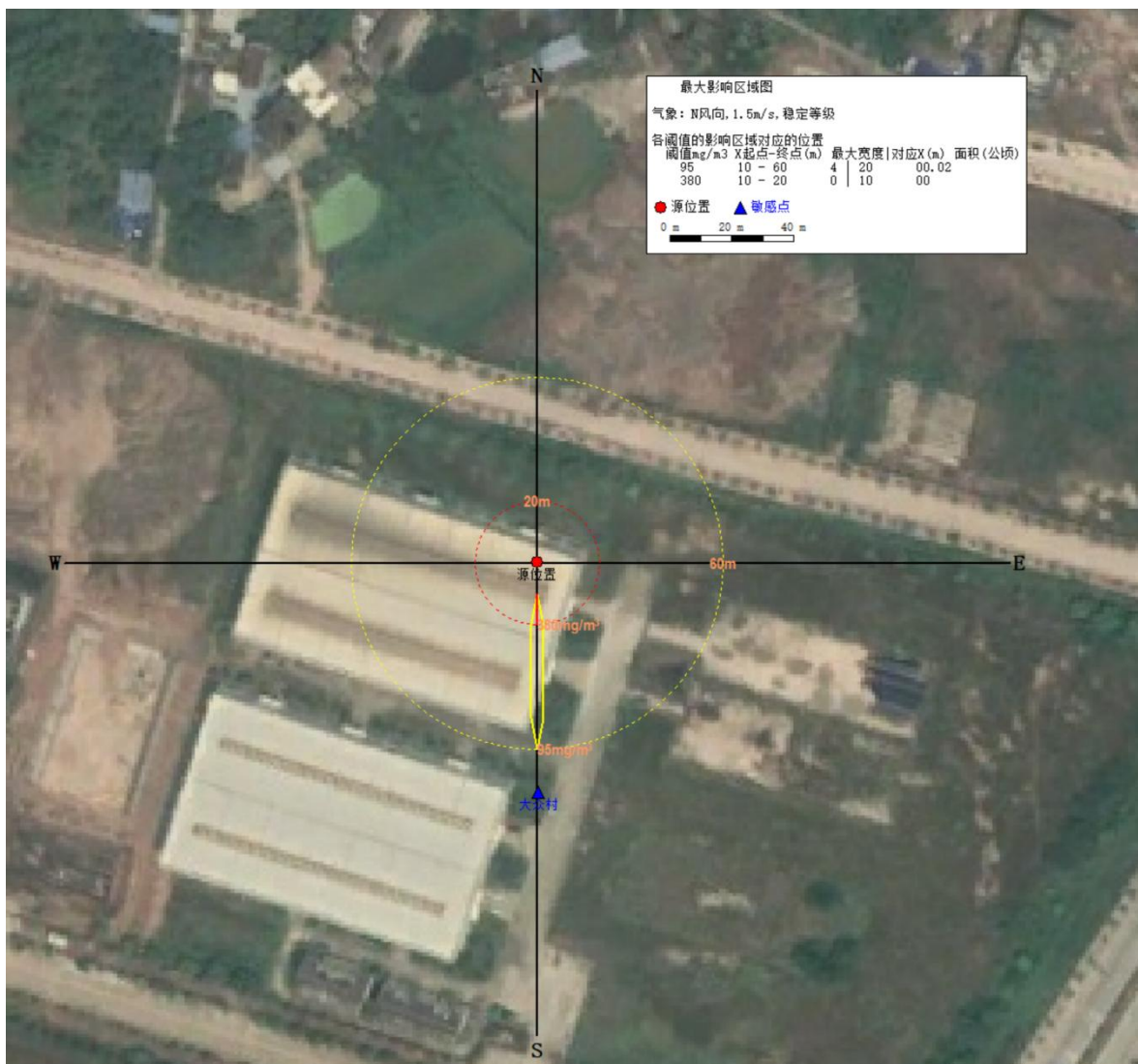
图 7.4-2 润滑油泄漏后发生火灾，伴生/次生 CO 影响范围图—最不利气象条件
