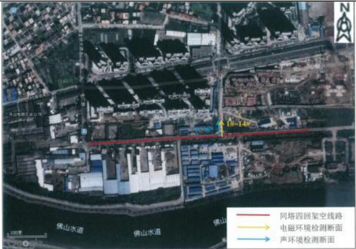
图 4.10-4 同塔四回架空线路噪声类比监测布点图
