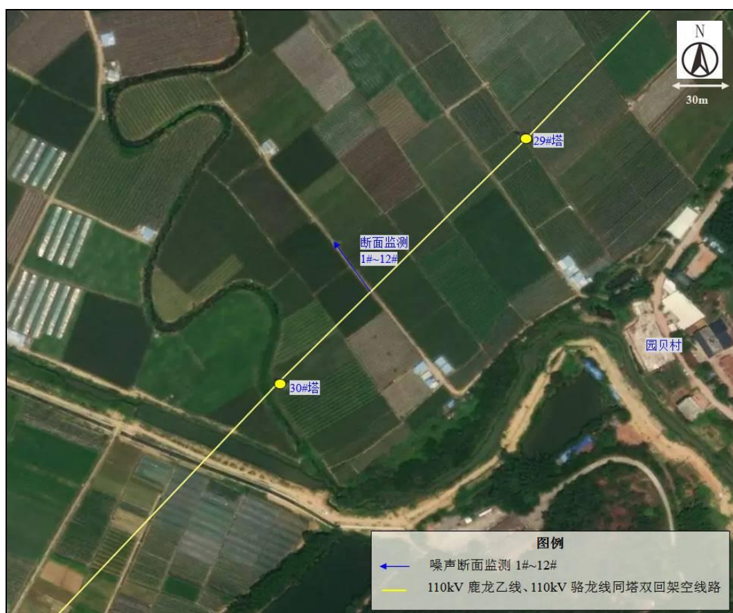
图 4.10-2 同塔双回架空线路噪声类比监测布点图
