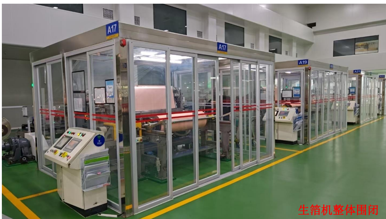
图5.1-5 生箔机密闭示意图
