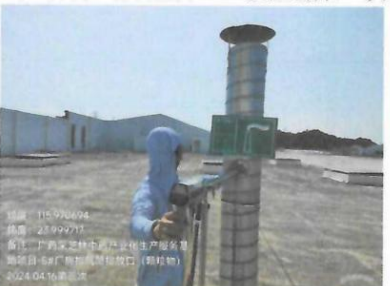
5#厂房排气筒排放口: 颗粒物第三次
