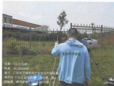
下风向监控点 3#: 无组织氨、臭气浓度、硫酸雾、硫化氢第一次
