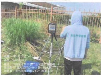
下风向监控点 4#: 无组织氨、臭气浓度、硫酸雾、硫化氢第二次
