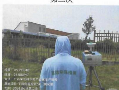
下风向监控点 3#: 无组织氯化氢、总悬浮颗粒物 第二次
