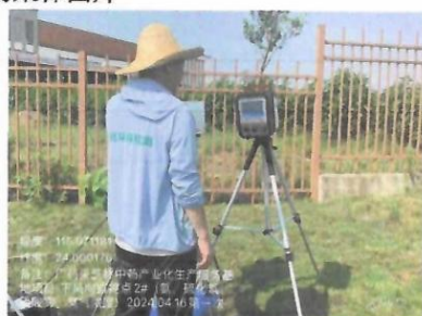
下风向监控点 2#: 无组织氨、臭气浓度、硫酸雾、硫化氢第一次
