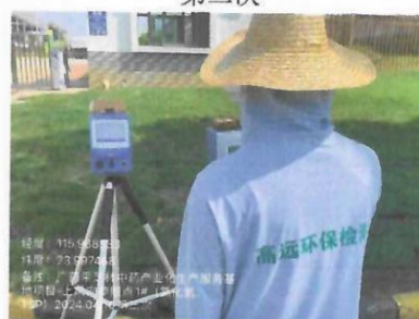
上风向参照点 1#: 无组织氯化氢、总悬浮颗粒物 第三次
