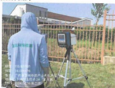
下风向监控点 2#: 无组织氯化氢、总悬浮颗粒物 第二次
