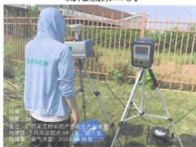
下风向监控点 3#: 无组织氨、臭气浓度、硫酸雾、硫化氢第二次
