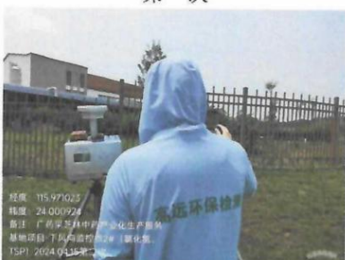
下风向监控点 2#: 无组织氯化氢、总悬浮颗粒物 第二次
