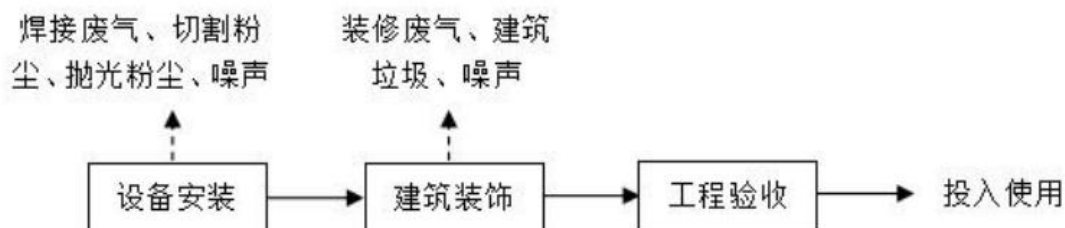
图 3.4-1 施工期工艺流程及产污节点图
