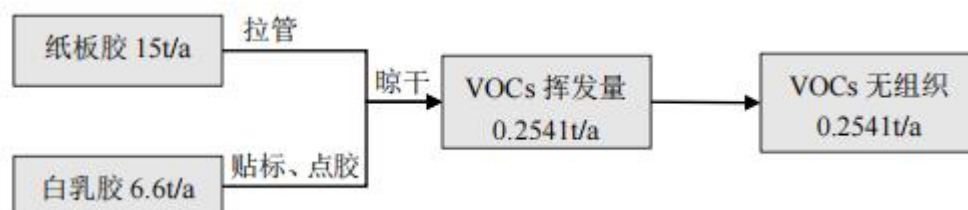
图 2-2 本项目 VOCs 物料平衡图
