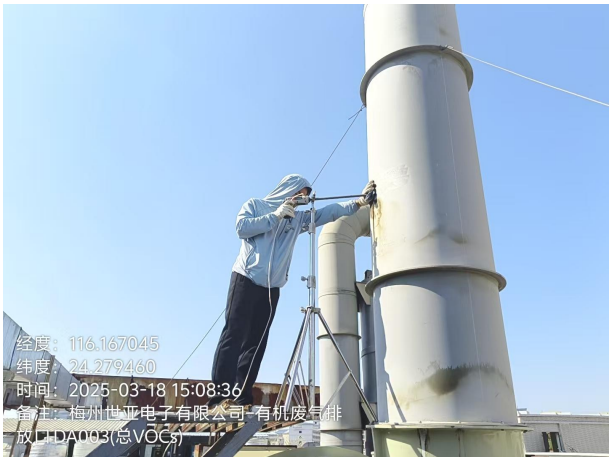
有机废气排放口 DA003：总 VOCs
