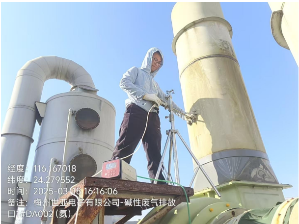
碱性废气排放口 1#DA002：氨
