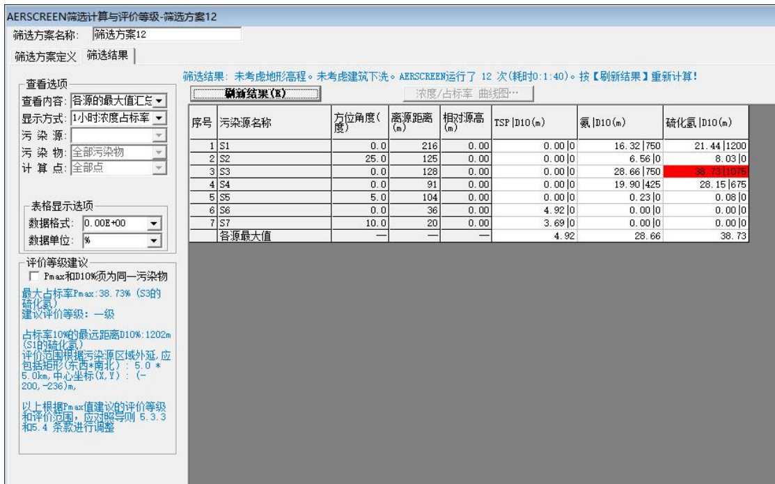
图 2.6-1 本项目废气中主要污染物 Pi 和 D10%计算结果
