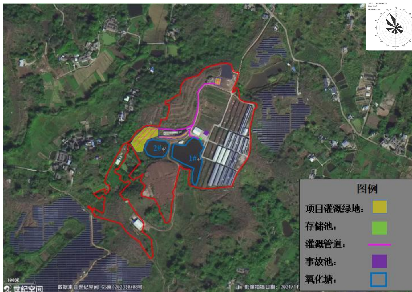
图 6.3-1 项目内绿化灌溉示意图
