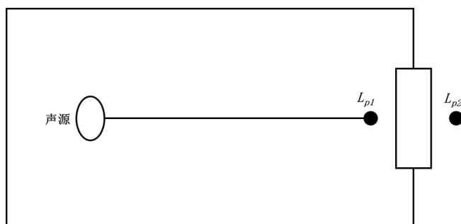
图 4-2 室内声源等效为室外声源图例
