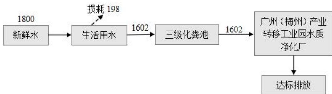
图 2-1 本项目水平衡示意图 单位：m<sup>3</sup>/a
