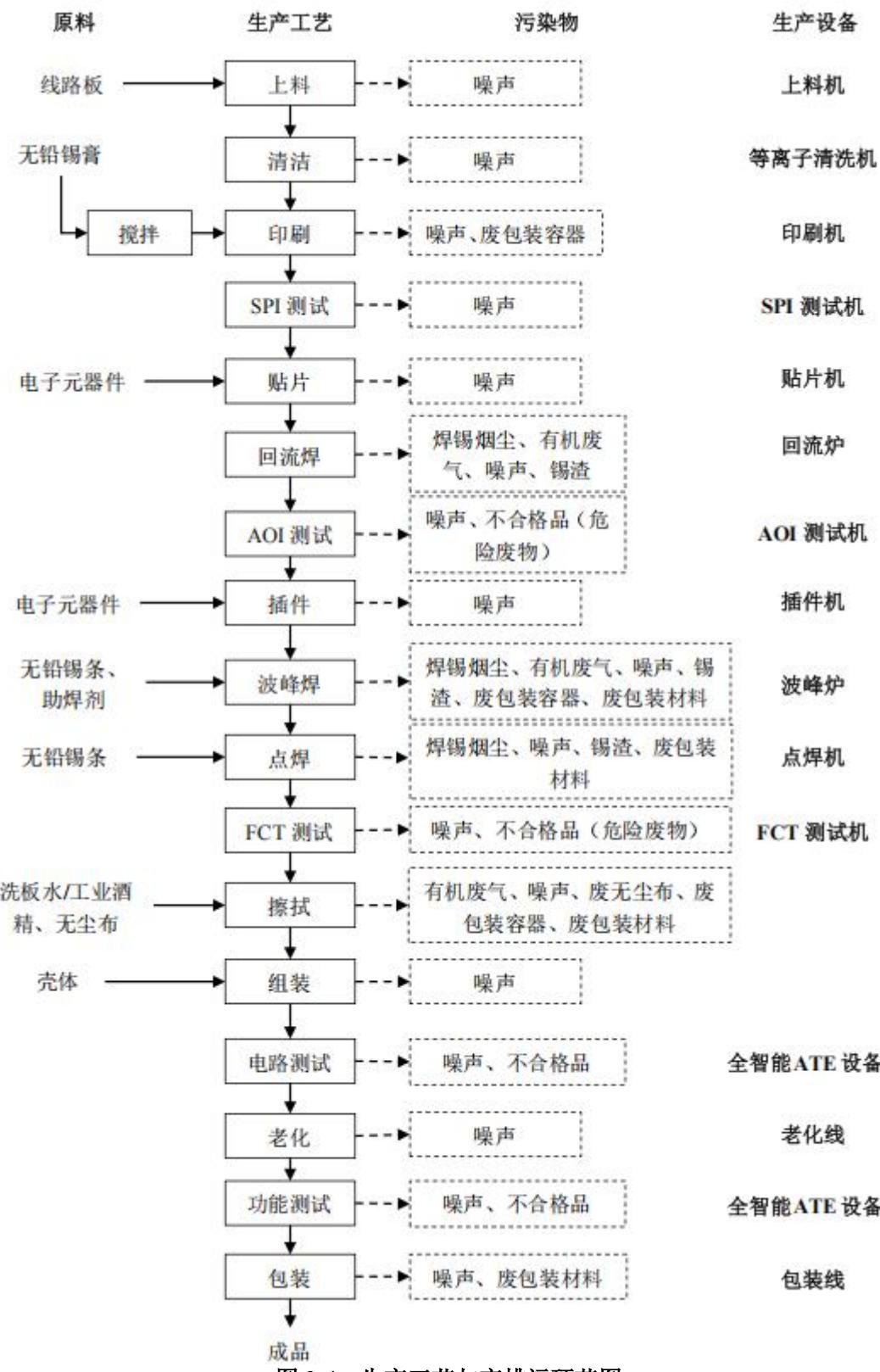
图 2-4 生产工艺与产排污环节图
