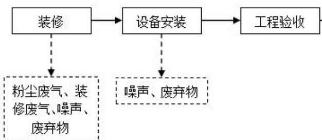
图 2-3 施工期工艺流程图
