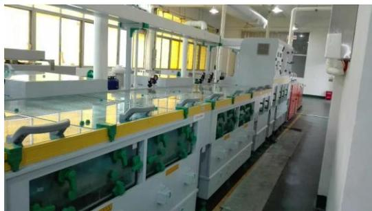
图 3-4 蚀刻、退膜机
