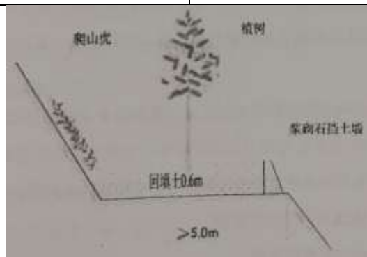
图 6.11-1 台阶复绿设计示意图
