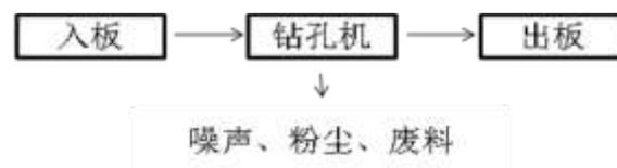
图 3.7-5 钻孔工序工艺流程及产污节点图
