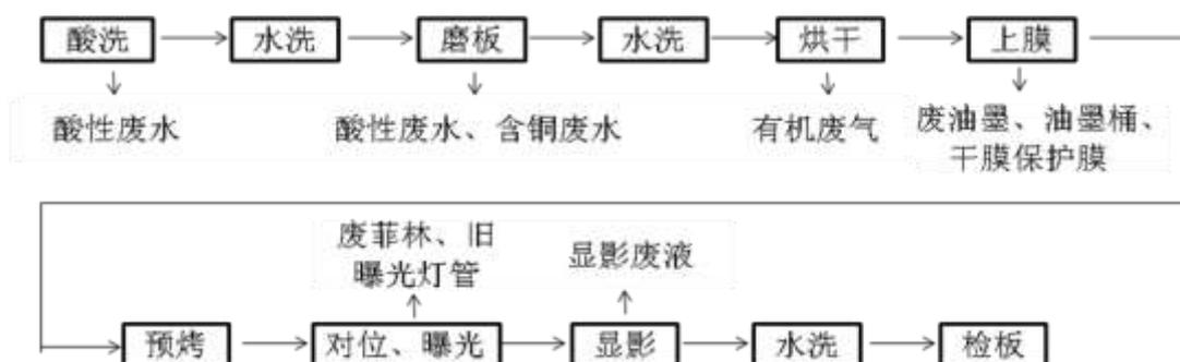
图 3.7-9 图形转移工艺流程及产污节点图
