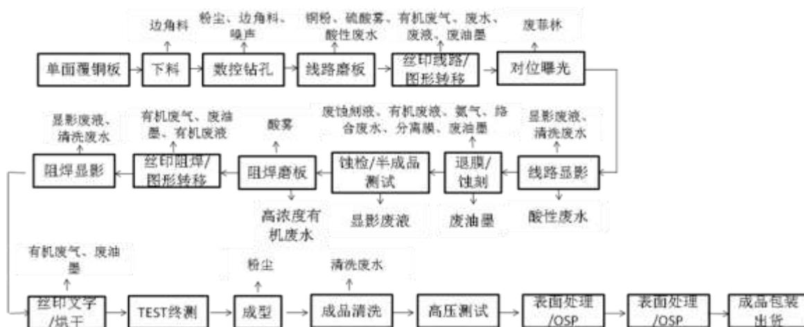
图 4.4-1 生产工艺流程及产污环节图
