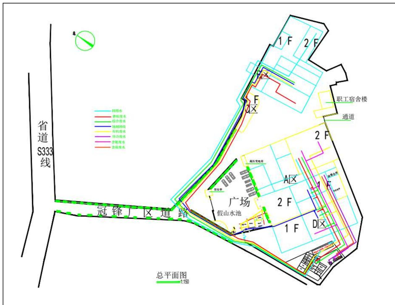
图 4.3-5 技改后全厂排水管网图
