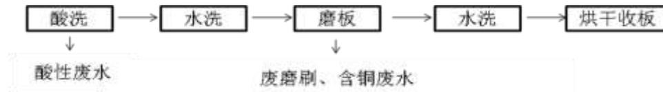
图 3.7-4 磨板工序工艺流程及产污节点图
