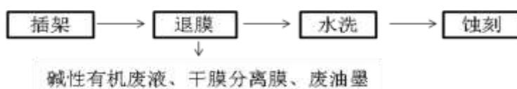
图 3.7-11 退膜工序工艺流程及产污节点图
