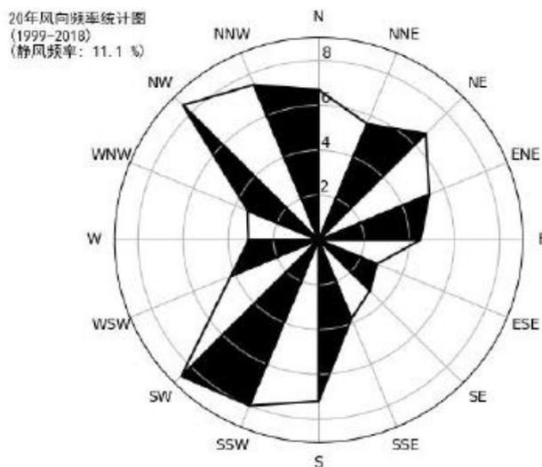
**图 5.2-1 五华风向玫瑰图（静风频率 11.1%）**
