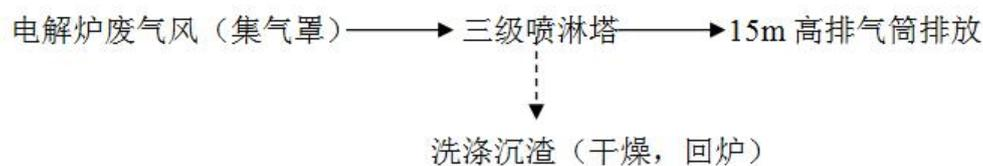
图 8.3-1 废气处理流程图
