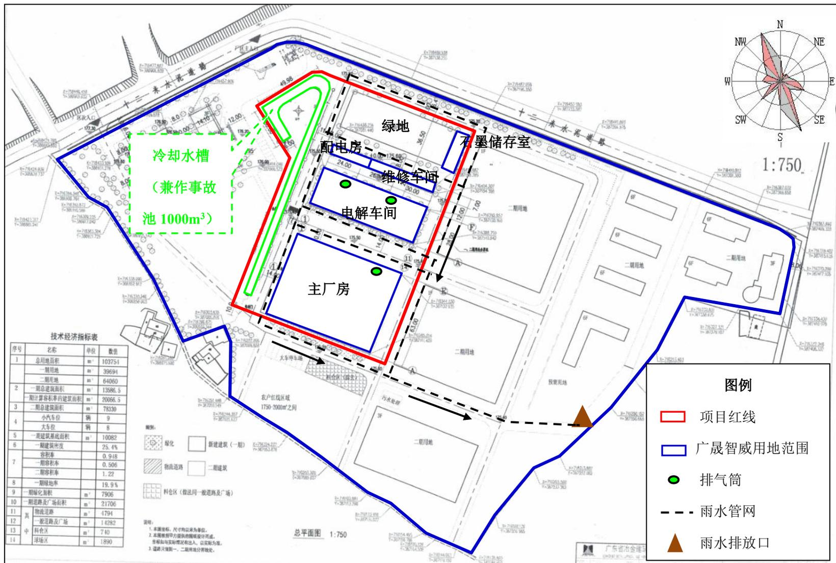
图 4.1-3 本项目总平面布置图
