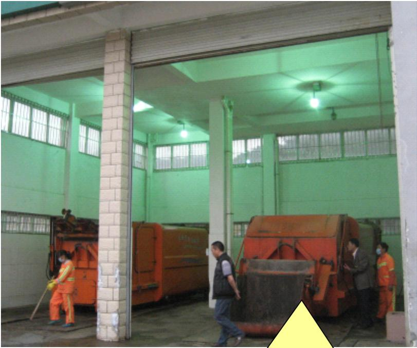
可移动式垃圾厢，带压缩装置
